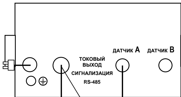
Блок преобразовательный щитового исполнения (вид сзади)
