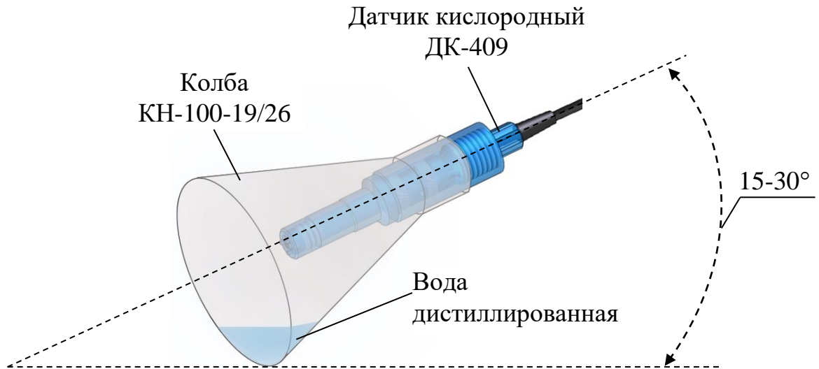
Рисунок 2.8 – Градуировка датчика ДК-409
