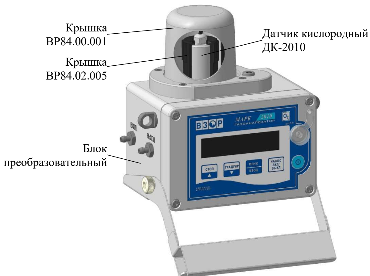
Рисунок 1.1 – Газоанализатор МАРК-2010 (вид с местным разрезом)
